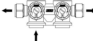
**DESTRO (CROMATO):** Costituisce il collettore per l'allacciamento di tubazioni distributrici con ingresso da destra. Sul collettore stesso vi è una freccia che indica la direzione del flusso.
