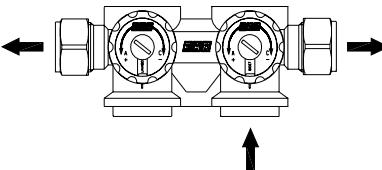
Ручки комплектуются двумя двусторонними дисками. Сине-красный диск имеет оконце, в котором с помощью второго диска можно указывать наименование помещения.
