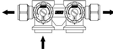
**ПРАВЫЙ (ХРОМИРОВАННЫЙ):** коллектор с правым раздаточным каналом для подсоединения труб с холодной водой. На коллекторном модуле имеется стрелка показывающая направление потока.
