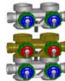
Inserire la vite art.8551 nel foro situato tra i due attacchi come indicato in figura. Prima di assemblare il collettore, assicurarsi di aver montato gli O-Ring di tenuta art.8350 2824.
