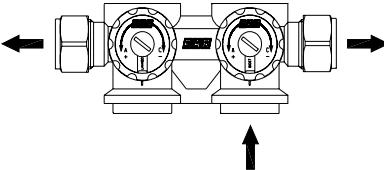
Tramite un dischetto serigrafato, è possibile indicare l'utenza alla quale la derivazione è connessa in modo da sapere con precisione, nel caso si debba intervenire per la sostituzione o la riparazione di un sanitario, a quale sanitario si è allacciati.
