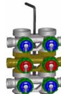
установить коллекторные модули друг в друга, вставить ключ (арт.6251) в верхнее отверстие так, чтобы он легко двигался. Завернуть винт до упора.
